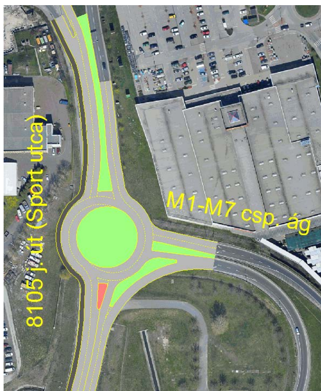
7.6. ábra 8105 j. út – M1-M7 ap. északi csomóponti ágak becsatlakozásánál kialakítható spirál rendszerű körforgalmú csomópont
