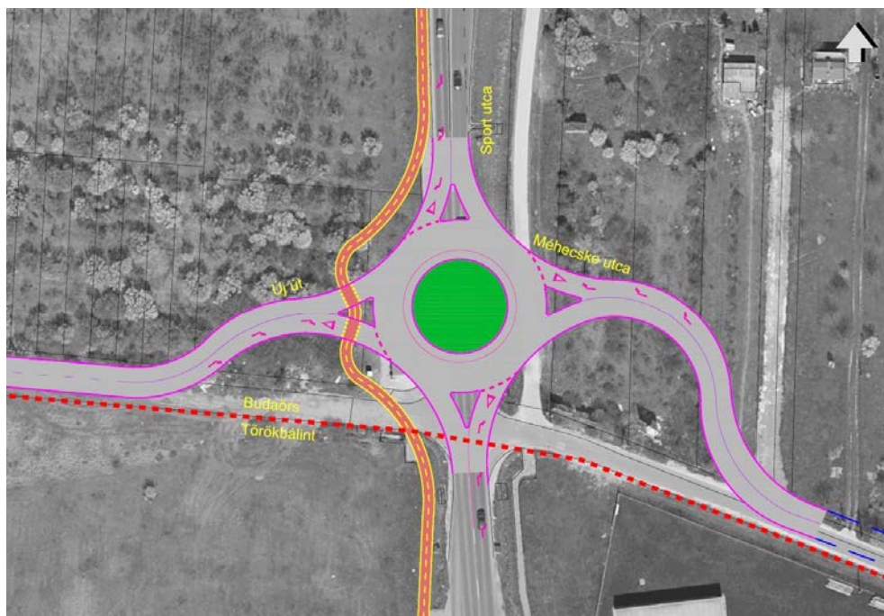
7.77. ábra Méhecske utcai csomópont 2. kialakítása
