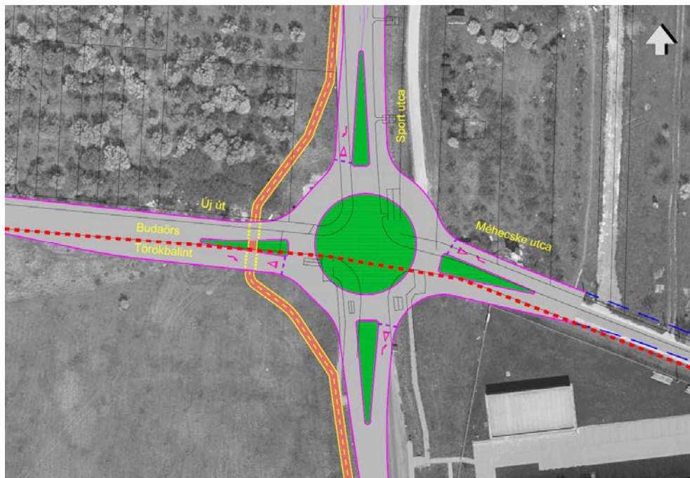
7.76. ábra Méhecske utcai csomópont 1. kialakítása
